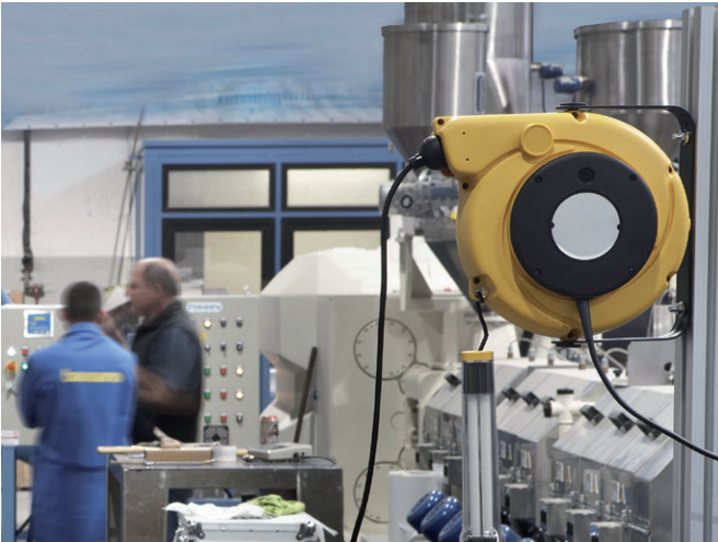
Fertig bestückte und voreingestellte Zugkabelrolle
